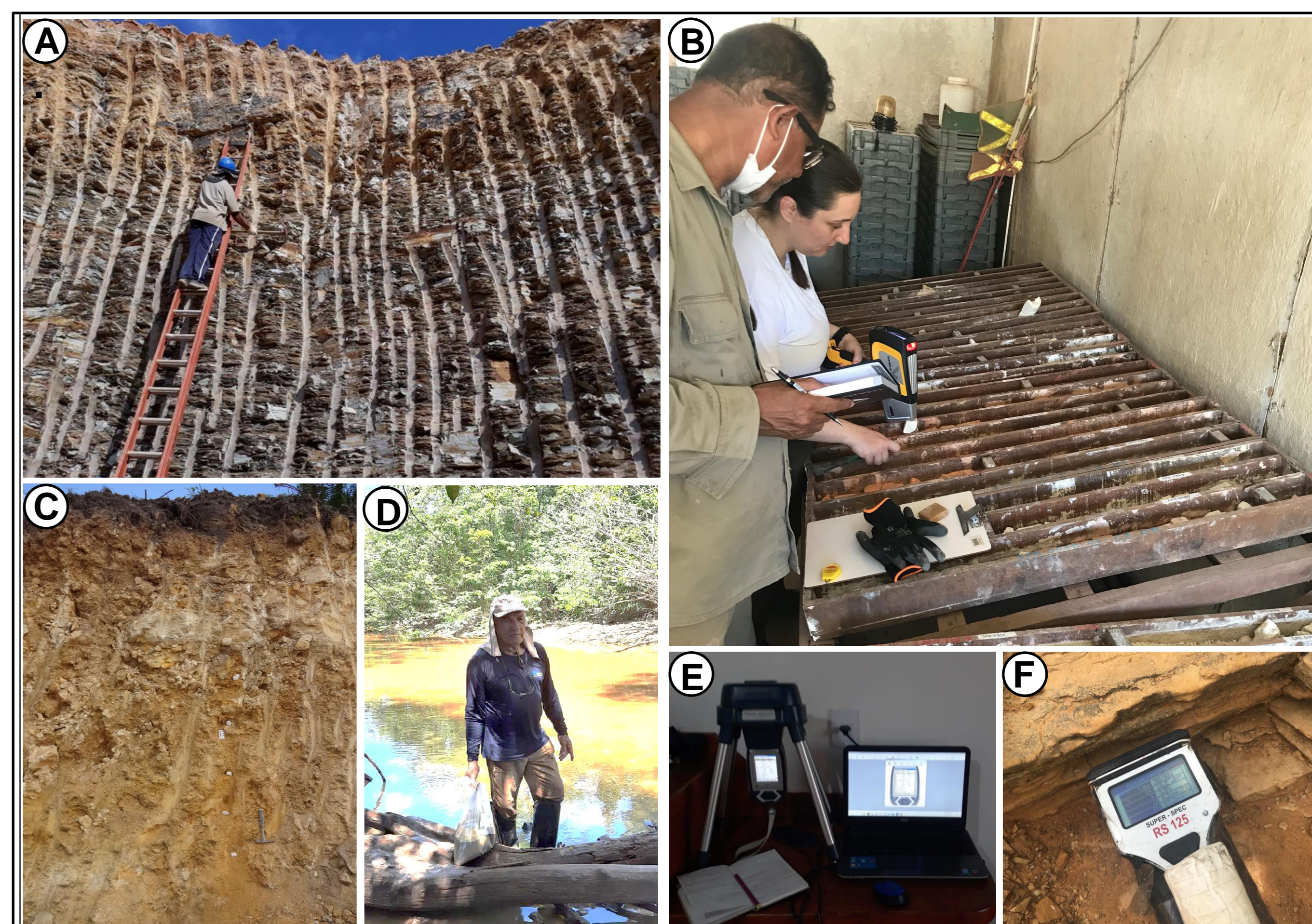
Figura 2. Metodologia de trabalho do Projeto Fosfato: A) técnico coletando amostra de rocha em perfil estratigráfico na Fm. Ponta Grossa (MS) a cada 50 cm; B) Análise por FRXp em furo de sondagem na mina Viso (PA); C) coleta em perfil de alteração de amostra a cada 50 cm na mina Viso (PA); D) Coleta de concentrado de minerais pesados em drenagem no NE do Pará; E) Estação de análise montada em campo de FRX; Análise de gamaespectrometria na Fm. Inajá (PE).
