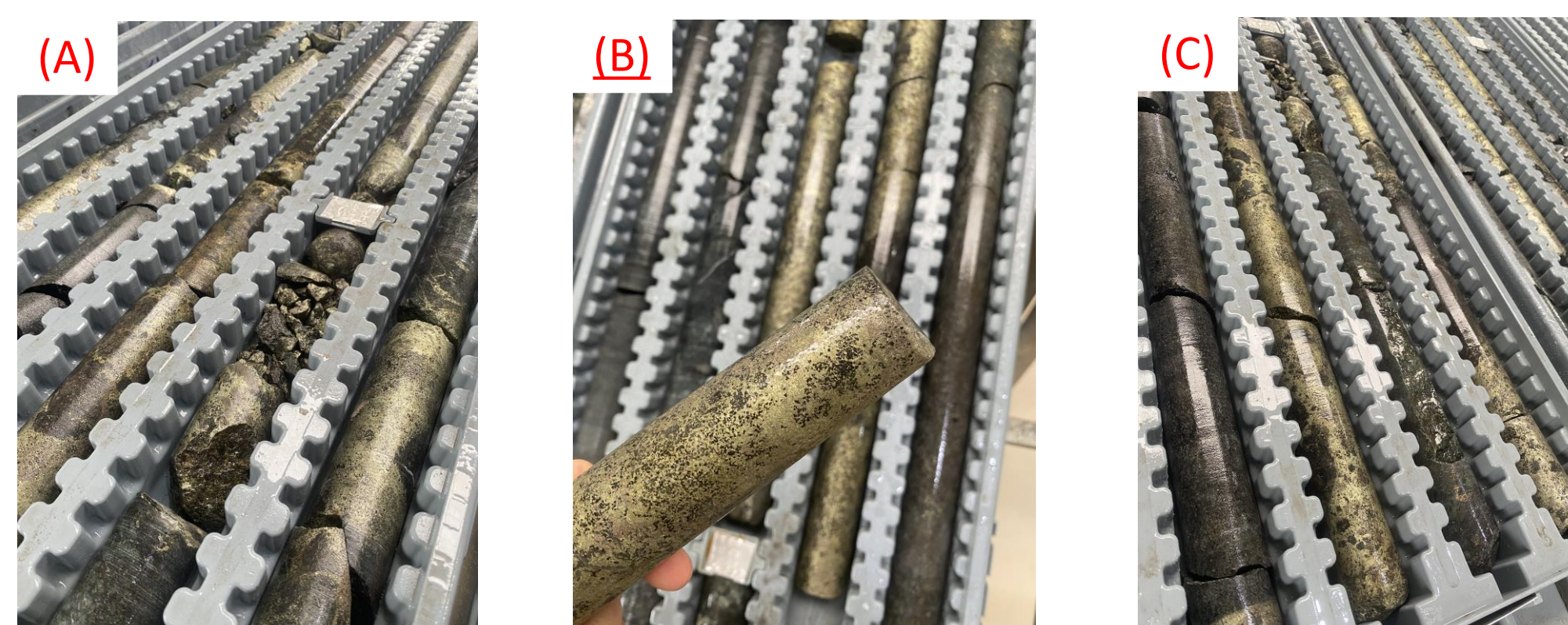
Fotografia de detalhe do furo exploratório FVS-1537 (A): Piroxenito com alteração por flogopitização com mineralização de Cpy estilo brechada e disseminada; (B): Piroxenito com flogopita e Cpy +Pirrotita ( Po ) estilo maciça; (C): Piroxenito com flogopitização e mineralização de Cpy estilo brechada.
